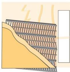
Pour arrêt de bétonnage, réservation et support d'enduit.
