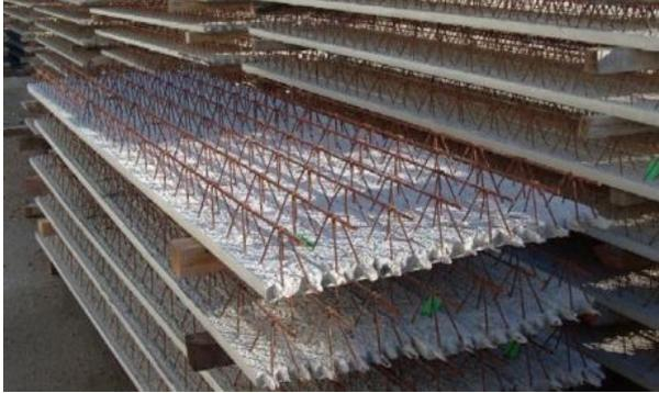
Les planchers poutrelles-hourdis sont utilisés dans la construction d'édifices ne comportant pas de portées importantes. La portée et la surcharge détermineront la hauteur de la poutrelle, les aciers employés et l'épaisseur de la dalle de compression.
