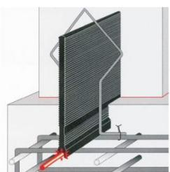
Pour traiter l'étanchéité entre la dalle et le voile (station d'épuration, bassin, piscine).
